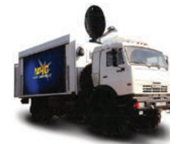
Мобильный комплекс информирования и оповещения населения на шасси автомобиля КАМАЗ
